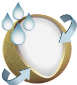
Sous l'influence de la température du sol, l'humidité traverse l'enrobage semi-perméable E-Max et dissout les éléments.
